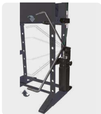
Dźwignia i pedał napędowy pompy — dowolność sposobu pracy
