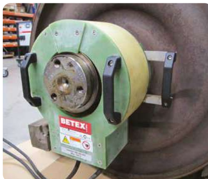
Nagrzewanie łożysk do demontażu
