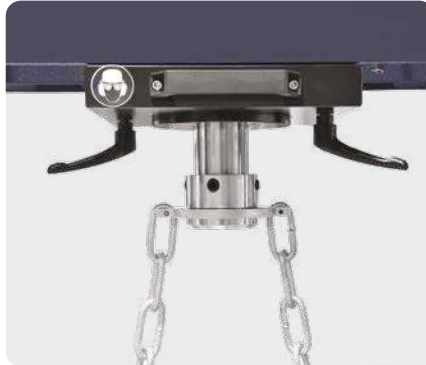
Regulacja stołu prasy: możesz ustawić stół prasy na określonej wysokości zakładając podkowę (z łańcuchem) na tłoku siłownika. Łańcuch mocuje się do stołu prasy. Za pomocą manipulatora możesz unieść lub opuścić stół, a następnie unieruchomić go sworzniami.
