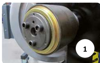
Stopniowy demontaż zespołów łożyskowych TBU / SP / TAROL
