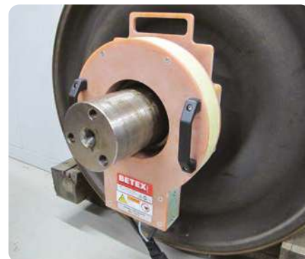
Nagrzewanie pierścieni labiryntowych do demontażu
