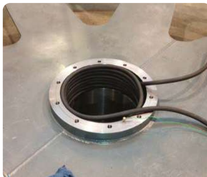
Nagrzewanie otworów przed montażem łożysk lub wałów
