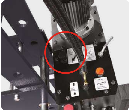
Regulacja siły nacisku: służy do tego to pokrętko.
