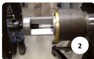
Stopniowy demontaż zespołów łożyskowych TBU / SP / TAROL
