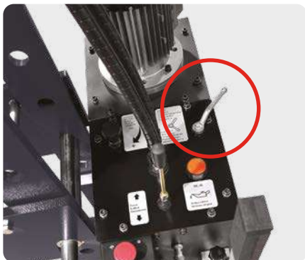
Prędkość: wyjątkowe rozwiązanie: — prasy WSPE mają dwie prędkości pracy tłoka! Tłok na 1. biegu porusza się \pm 2,3 mm/s. Tłok na 2. biegu porusza się \pm 9,5 mm/s. Gdy tylko tłok podczas szybkiego dojazdu wyczuje opór, automatycznie zmniejszy prędkość do 2,3 mm/s. Dokładne prędkości pracy zależą od poszczególnych typów pras.
