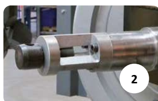
Stopniowy montaż zespołów łożyskowych TBU / SP / TAROL
