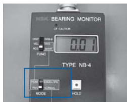
Rejestrowanie drgań od obrotów (NORMAL)
