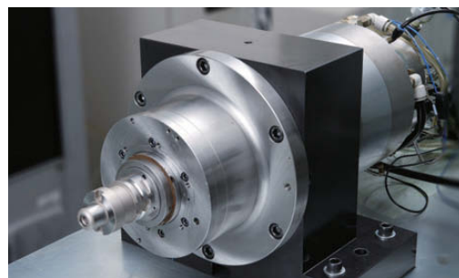
Wrzeczono NSK, które osiągnęło 4 miliony d_m n z użyciem łożysk z ceramicznymi kulkami
